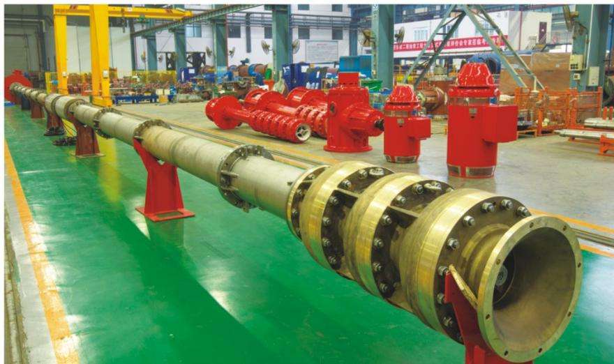
可生产适合于海水消防泵用的各种材质，包括：双相不锈钢，超级双相不锈钢，镍铝青铜等。
